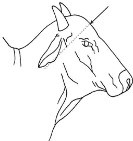
Figura No. 7. Punto de aplicación y dirección del pistolete para conseguir el aturdimiento en bovinos tipo cebú de la raza Indobrasil.
